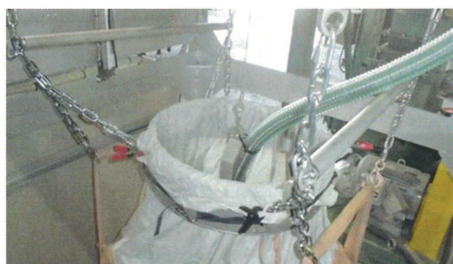
フレコン取付状態
